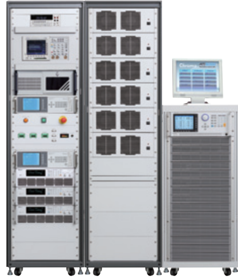
PV Inverter ATS
